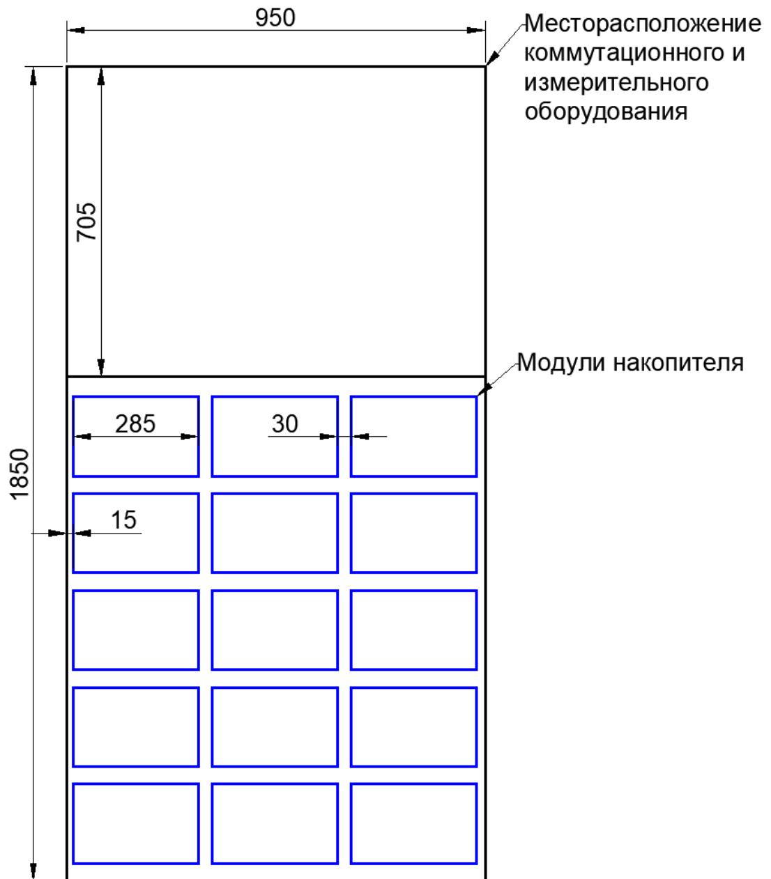
Рисунок 2.2 — схема конструкции одного накопительного шкафа (вид спереди) (размеры представлены в миллиметрах)
