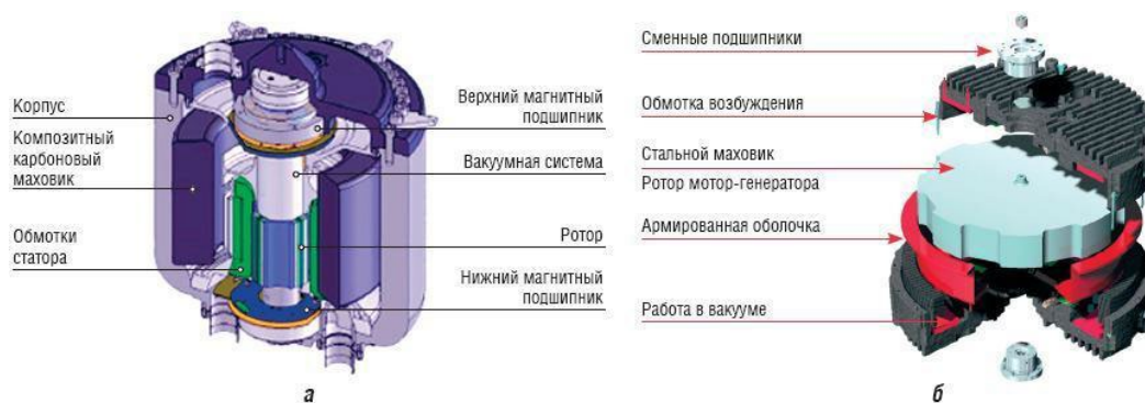
Рисунок 1.7 — Роторный накопитель кинетической энергии: а - компании Socomes; б - компании Active Power
