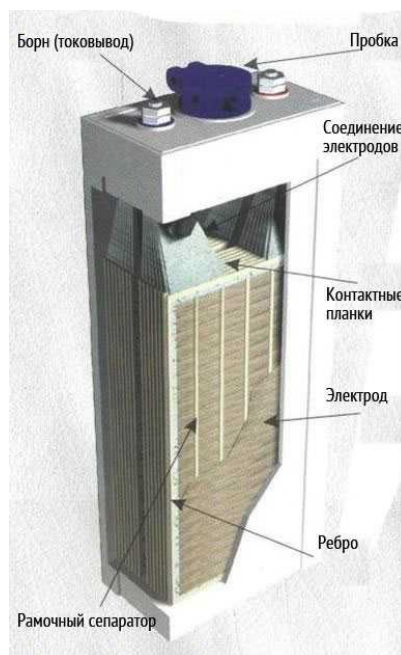
Рисунок 1.2 — Основные элементы щелочного никель кадмиевого аккумулятора серии KL
