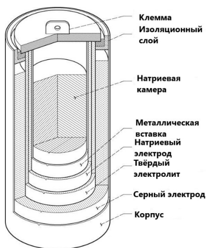
Рисунок 1.4 — Структурная схема натрий-серного аккумулятора
